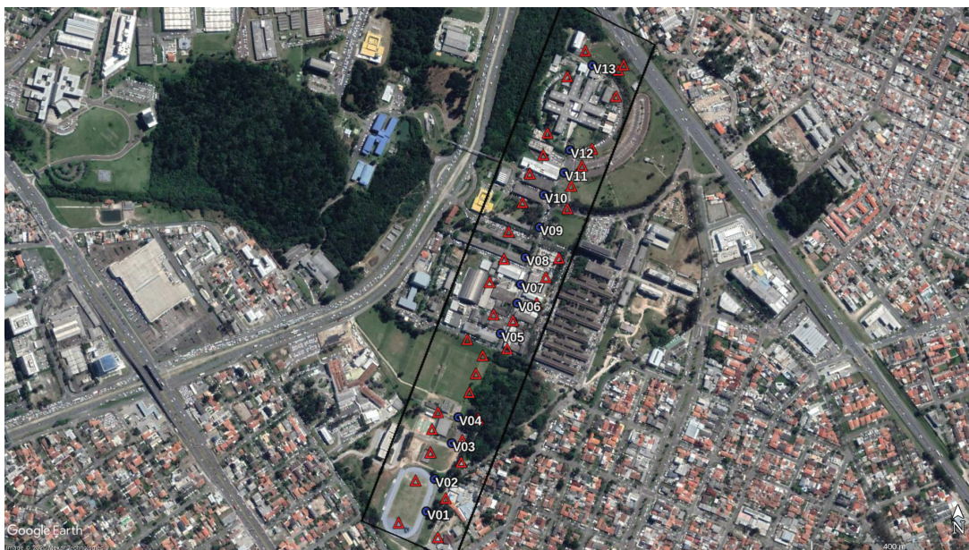
FIGURA 13 – PONTOS DE APOIO E VERIFICAÇÃO
