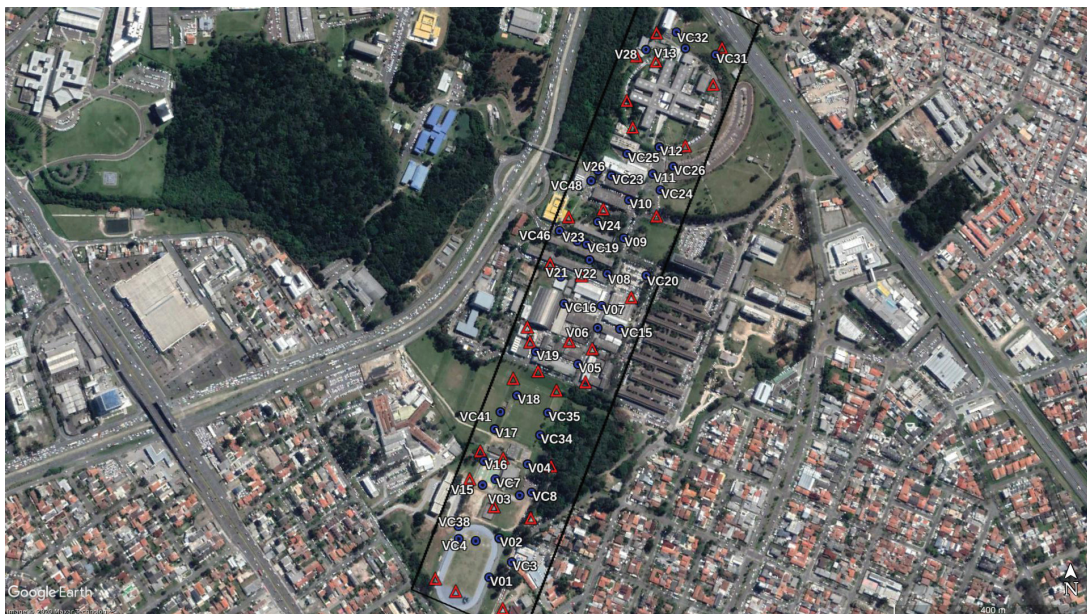
FIGURA 15 – PONTOS DE APOIO E VERIFICAÇÃO
