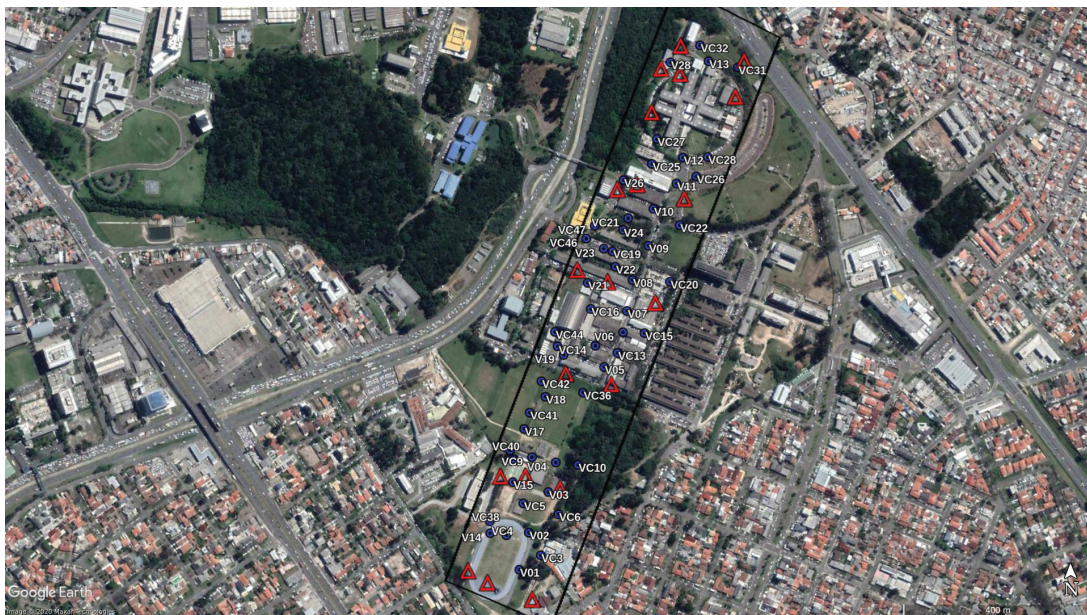
FIGURA 14 – PONTOS DE APOIO E VERIFICAÇÃO
