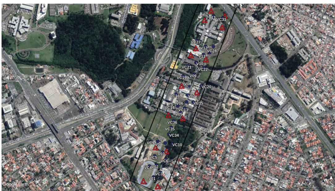
FIGURA 11 – PONTOS DE APOIO E VERIFICAÇÃO
